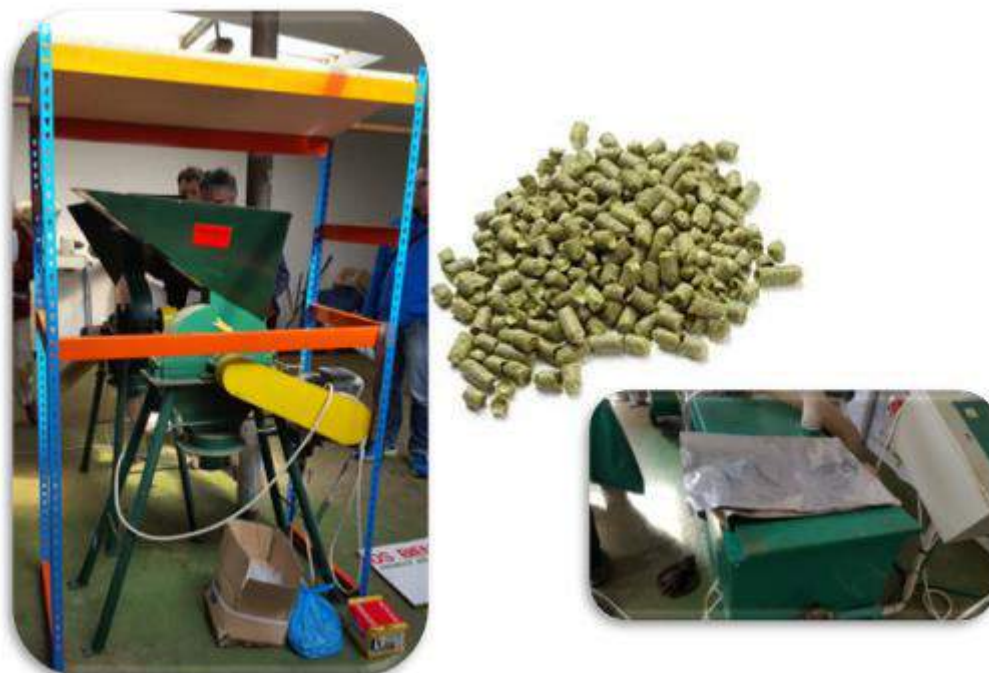
Figura 23. Peletizadora y bolsas de envasado en el Centro de Investigaciones Agrarias de Mabegondo (CIAM).
